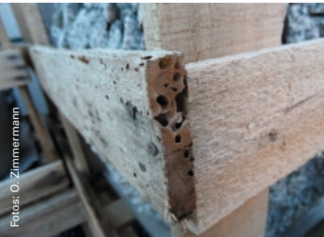
Bild 2 Bohrlöcher im Verpackungsholz.
