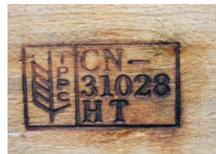
Bild 1 Die amtliche Markierung auf Verpackungsholz garantiert die phytosanitäre Behandlung (CN=China, HT=hitzebehandelt). Foto: P. Bauer
